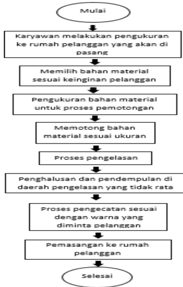
Gambar 3. Diagram alir proses produksi pengelasa pagar
